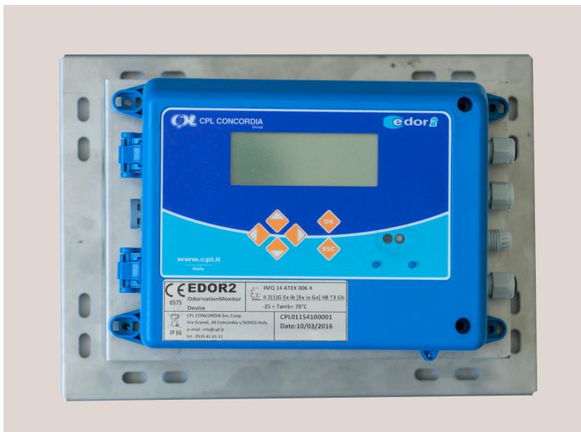
Grazie alla compensazione in temperatura operata dal software, si ottiene una buona precisione di misura, dipendente dalla quantità di impurità presente nel gas.
